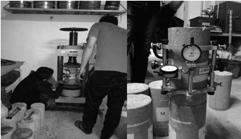
Hình 8. Thí nghiệm đo mô đun đàn hồi bê tông
