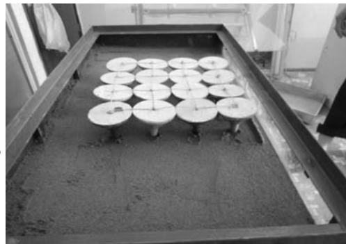
b/ Lắp đặt các khối top-block
