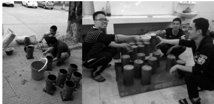
Hình 5. Hình ảnh về thi công và bảo dưỡng mẫu
