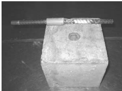
Mẫu thép bị kéo tuột khỏi bê tông
