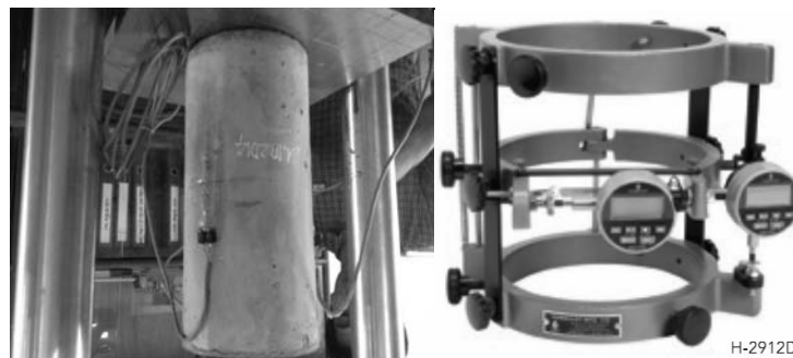
Hình 6. Thiết bị đo Mô đun đàn hồi bê tông
